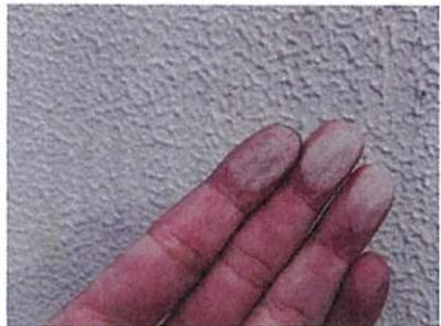
旧塗膜が紫外線・水分等の影響によって塗料樹脂が分解し表面が粉状
